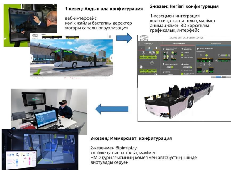
3-сурет – Қалалық автобусты виртуалды модельдеу кезеңдері - тұтынушының қалауы өнімге ертерек енгізіледі
